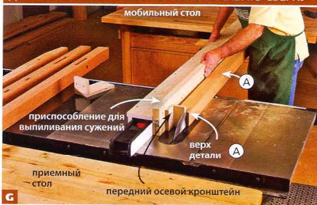
Г При выпиливании длинных сужений на колоннах установите спереди и позади пильного станка поддерживающие опоры.
