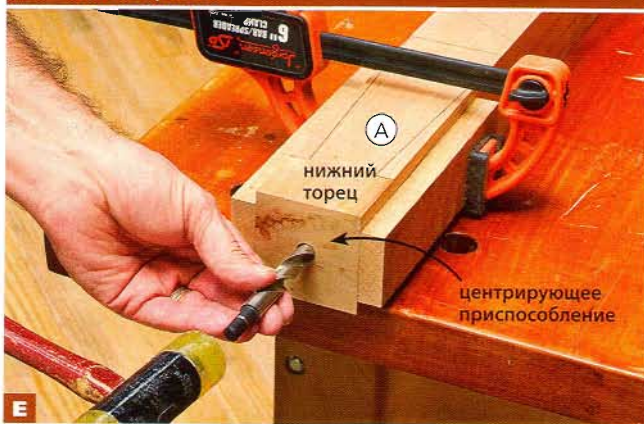
Е Струбциной прижмите центрирующее приспособление к нижнему торцу колонны А. Вставьте в отверстие 12 мм сверло по дереву и ударьте по его хвостовику киянкой.
