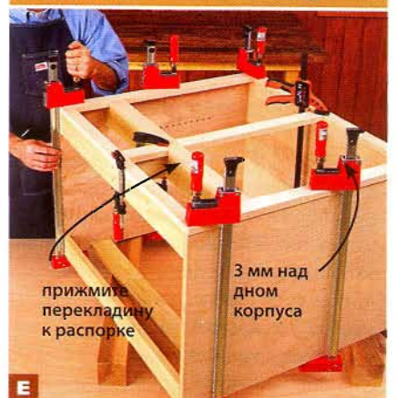
Чтобы прикрепить раму к корпусу, не потребуется множество струбцин. Однако убедитесь, что вы приклеили среднюю перекладину к средней распорке, проходящей под ящиком.
