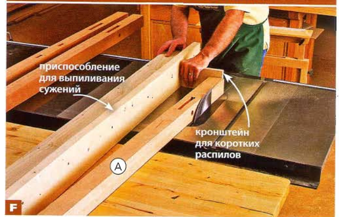
Ф Кронштейн для коротких распилов удерживает нижний торец колонны А на большем расстоянии от приспособления, чем кронштейн для длинных.
