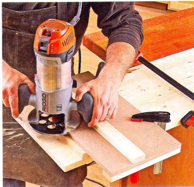
Для удаления лишнего материала зафиксируйте фрезерный край приспособления на расстоянии около 10 мм от торцов деталей, а затем сделайте несколько проходов фрезой до пропила, переставляя приспособление.
