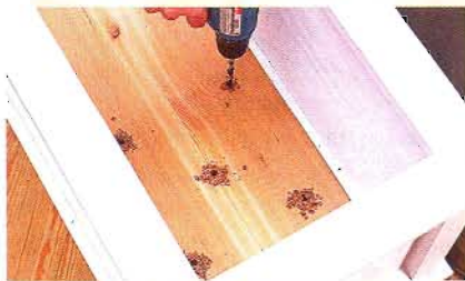
Просверлите дренажные отверстия для стока воды в дне цветочного ящика.
