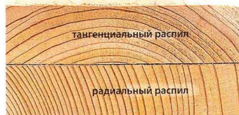
Менее стабильная рядовая доска (вверху) изменяется в ширину почти вдвое заметнее, чем доска радиального распила.
